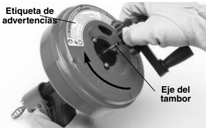
Figura 2 – Extracción de la manivela fuera del Power-Spin
